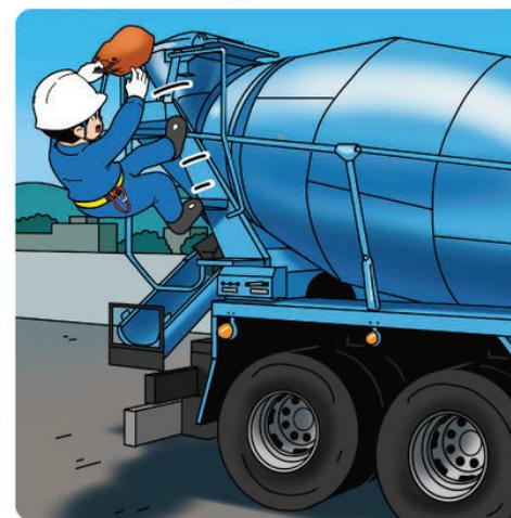
荷降ろし作業時の墜落災害防止を意識した積み込みを!
