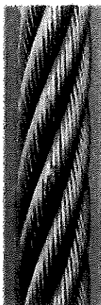
クラウン断線 (山切れ断線)
