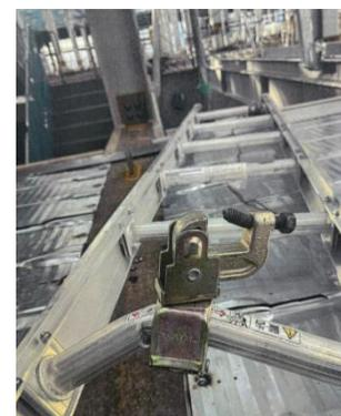
写真A: 外れていない下部キャッチクランプ
